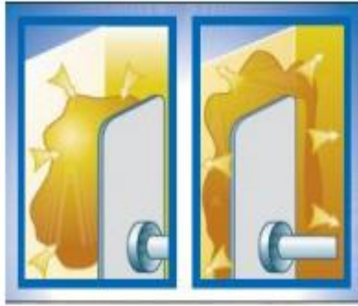
Şekil 2.1: Stomacher'ın pedal hareketi
